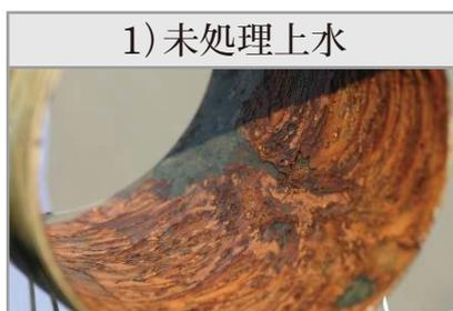
腐食生成物がテストピースの全面を覆っている。剥離しやすい粗い構造の鉄酸化物です。
