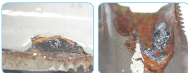
ビニール被膜と地金の上に浸入した水によって進行した管の劣化。この事例も散見されましたが、すべて写真のように、黒錆化しており、劣化をストップさせていました。
