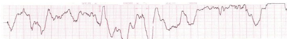
未処理井水テストピースの凹凸
